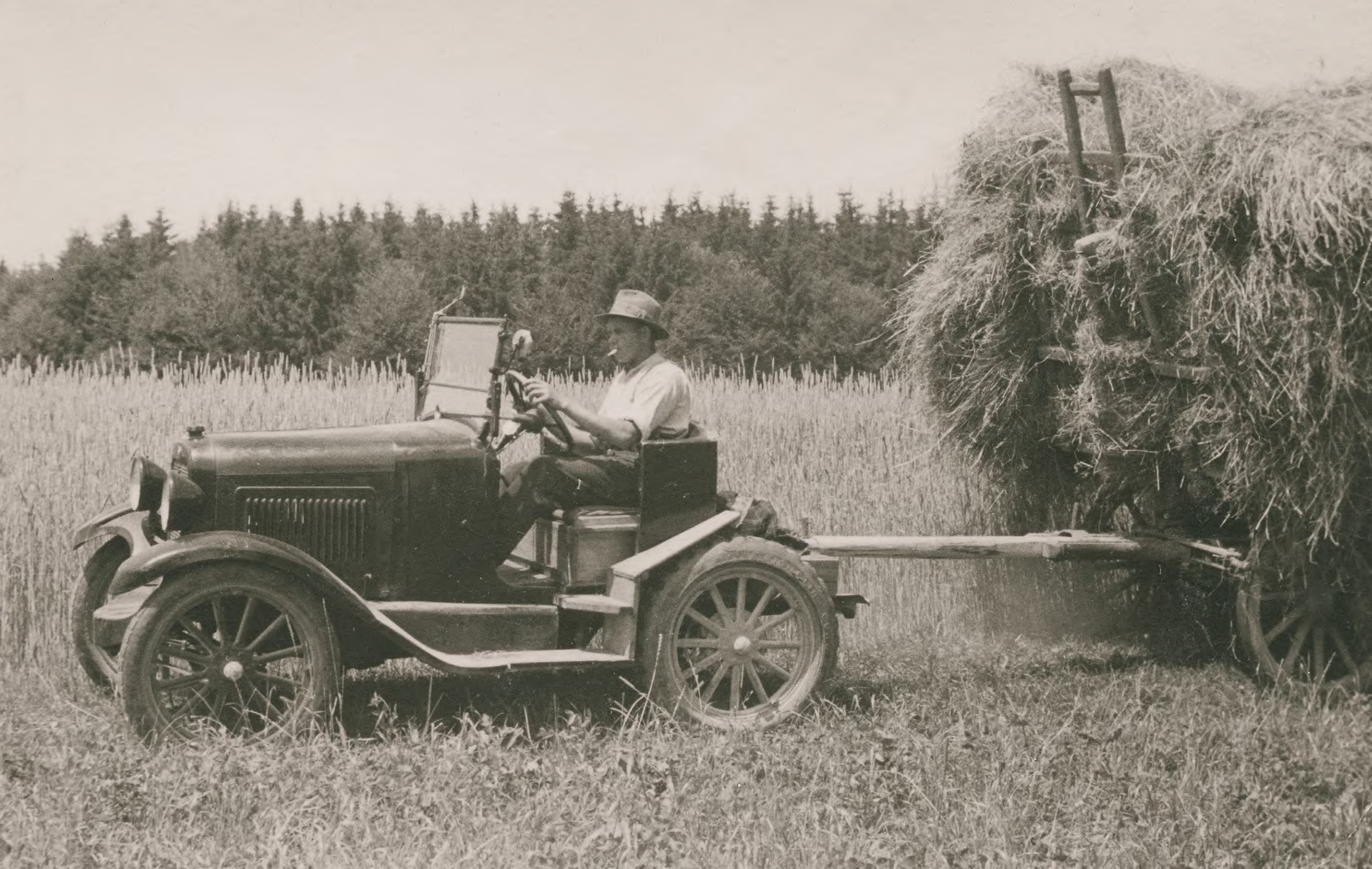
Hans Arn auf seinem alten Ford, den er zum Autotraktor umgebaut hat, Ottiswil, um 1935
